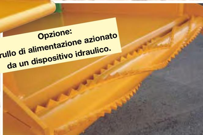
Una caratteristica particolare delle macchine della serie K è il rullo alimentatore di 80 cm di diametro ed il piano di alimentazione apribile.
