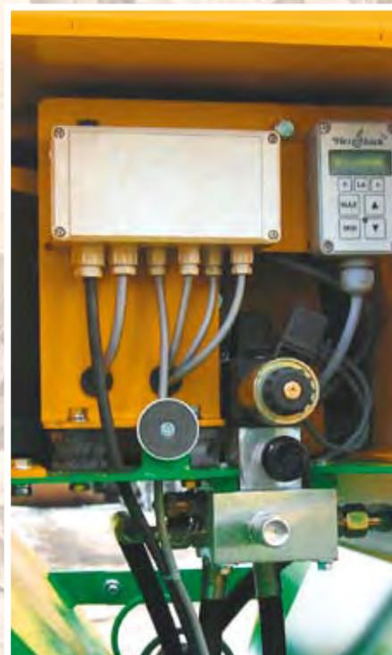
Il sistema di comando HEIZOHACK HE 002 regola l'immissione del materiale in funzione della potenza a disposizione. Un contatore integrato rileva le ore giornaliere e quelle complessive di funzionamento.
