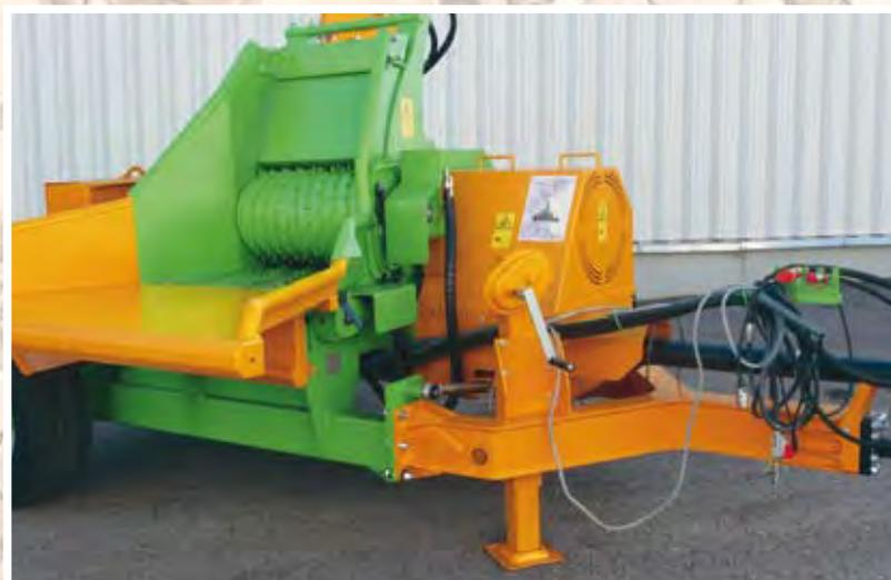
Questa serie di macchine è stata ideata per consentire ai contoterzisti la produzione di cippato. Le potenti macchine cippatrici sono state sviluppate per poter essere alimentate con una gru.
