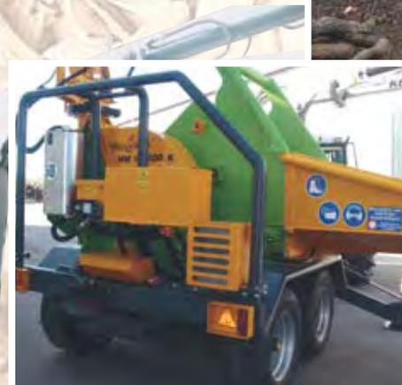
Al fine di consentire il montaggio di una gru, questa cippatrice è montata su un telaio tandem.
