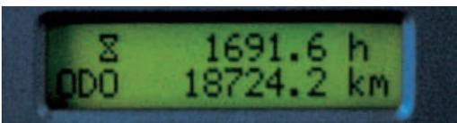
Liegt am Muldenkipper eine Störung vor oder steht eine Wartung bzw. Inspektion an, werden dort, wo normalerweise Betriebsstunden-/Kilometerzähler angezeigt werden, eine Klartextmeldung und ein Actioncode angezeigt. Bei jeder Betätigung des Startschalters wird das System erneut überprüft. Steht ein Filter- oder Ölwechsel an, wird dies durch eine Wartungskontrollleuchte kenntlich gemacht und der zu wechselnde Filter bzw. das Öl wird angezeigt.
