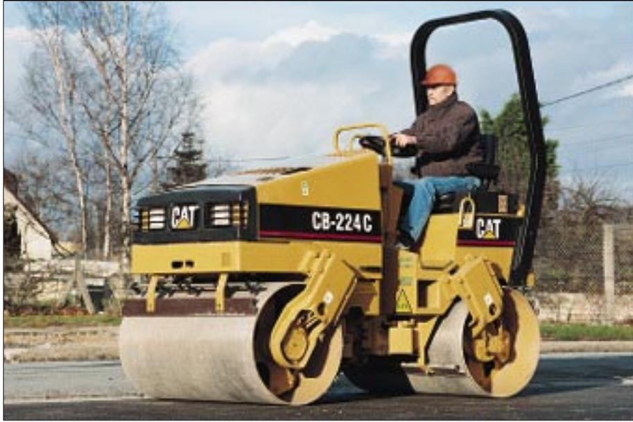
Aus der optimalen Kombination von **Bandagengewicht, Frequenz und Amplitude** resultiert ein leistungsfähiges Vibrationssystem mit höchster Verdichtungswirkung.
