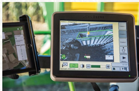
L'operatore può vedere chiaramente livello di riempimento del rimorchio
