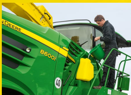
Serbatoio da 30 l per additivi concentrati
