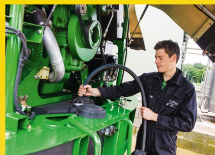
Serbatoio posteriore da 360 l
