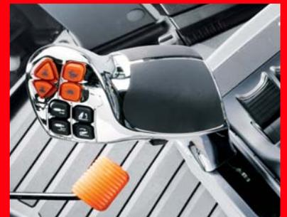
...appuyez sur le bouton Powershuttle sur le Multicontroller.
