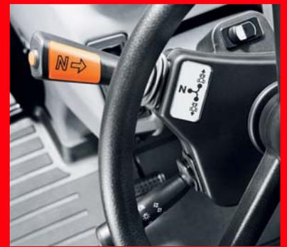
Afin de changer de direction, actionnez simplement le levier du Powershuttle ou ...
