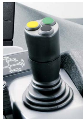
**Le levier en croix STEYR\*** pour toutes les fonctions du chargeur est à portée de main, intégré dans la disposition ergonomique des commandes de la cabine.
