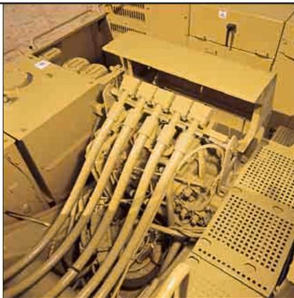
**Bauteilanordnung.** Hydraulikpumpen, Hauptsteuerblock und Hydrauliköltank wurden möglichst dicht beieinander platziert, um die Länge der Rohrleitungen zu minimieren. Das Schwenkventil ist direkt auf dem Schwenkmotor angebracht. Saug- und Druckleitungen der Haupt- und Schwenkpumpen weisen besonders große Durchmesser auf. Alle diese Einzelmaßnahmen verhelfen dem Hydrauliksystem zu einem beeindruckenden Wirkungsgrad.
