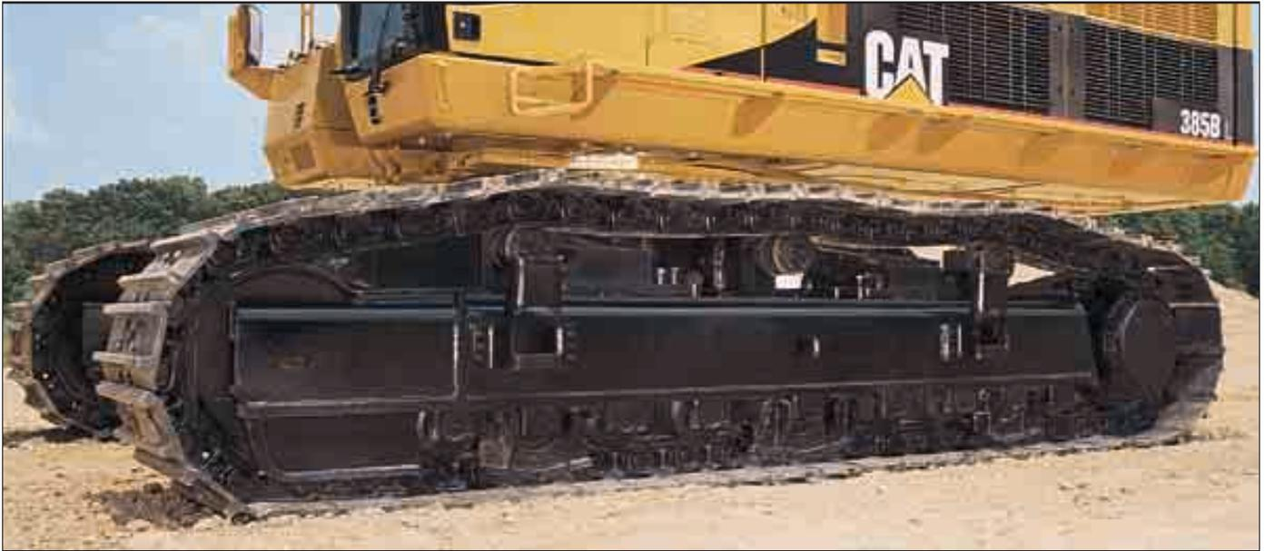
**Unterwagen.** Um den Transport des 385B zu erleichtern, lassen sich die angeschraubten Laufrollenrahmen mechanisch einfahren. Dadurch verringert sich die Maschinenbreite bei Ausrüstung mit 650-mm-Bodenplatten auf 3,40 m. Aufgrund der neuen, säulenlosen Konstruktion des Unterwagenrahmens ist der Drehkranz direkt auf dem Oberblech des Rahmens angebracht, sodass die Dauerfestigkeit deutlich erhöht wird.
