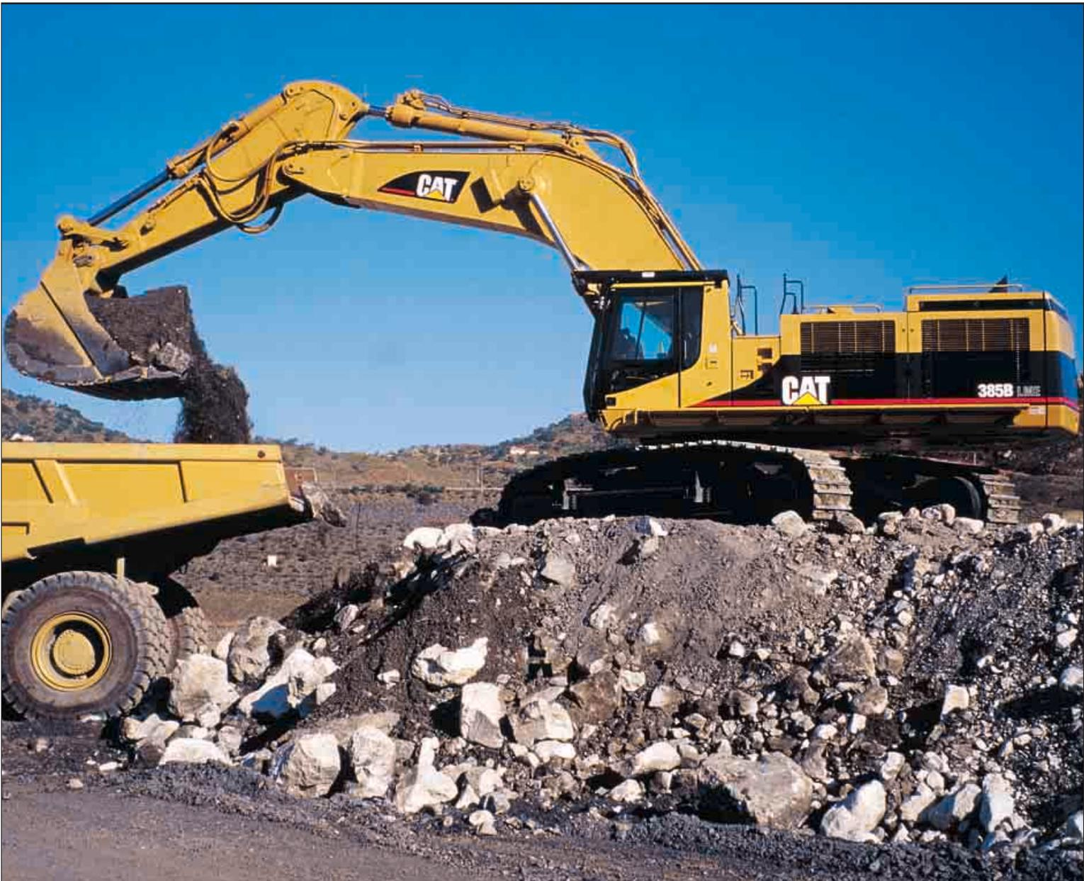
**Hydrauliksystem.** Im 385B wird die bewährte Load-Sensing-Hydraulik mit drei Pumpen, unabhängigem Schwenkkreis, proportionaler Durchflussverteilung und lastdruckunabhängiger Volumenstromsteuerung angewendet. Neu hinzugekommen ist die von Caterpillar selbst entwickelte elektronisch-hydraulische Betätigung, die maßgeblich zur überragenden Energiebilanz und Produktivität der Maschine beiträgt.
