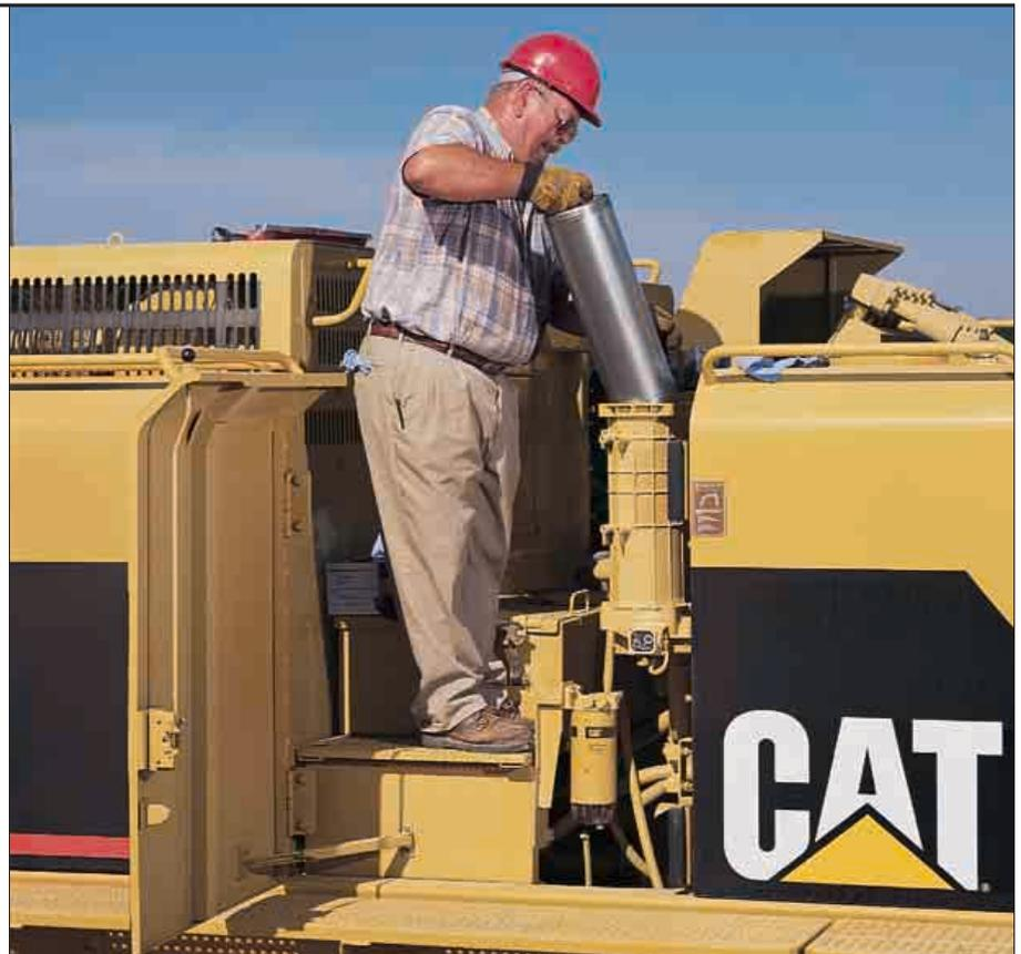
**Wasserabscheider.** Leicht erreichbar im Batteriekasten angeordneter Kraftstoff-Wasserabscheider (lässt sich auch entleeren, wenn das System unter Druck steht).
