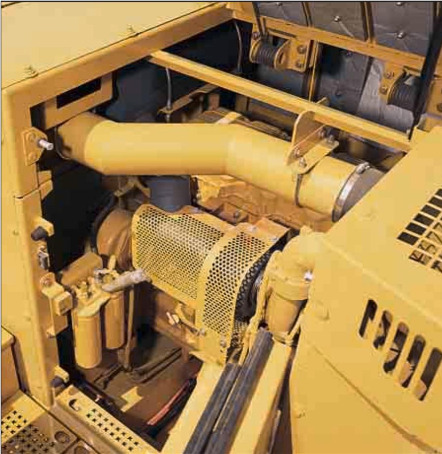
**Motorblock.** Der hochfeste Gusseisenblock des 3456 entsteht unter strengsten Qualitätskontrollen in der unternehmenseigenen Gießerei. Dank des weit über die Kurbelwellenmitte nach unten gezogenen Kurbelgehäuses und der Mindestzugfestigkeit von über 200 N/mm<sup>2</sup> bietet der Block eine hervorragende Verwindungssteifigkeit und Dauerfestigkeit.
