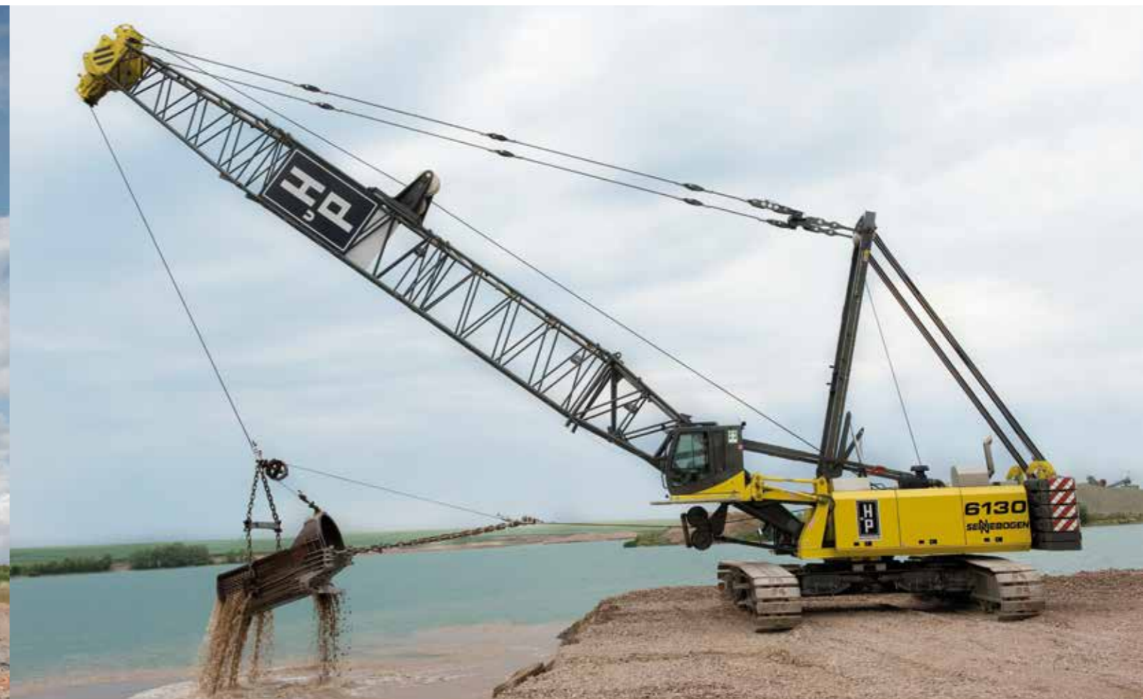
6130 HD – Sand and gravel quarrying with 5,6 cubic yards dragline bucket; Germany 6130 HD – Sand und Kiesförderung mit 4,3 m³ Schleppschaufel; Deutschland
