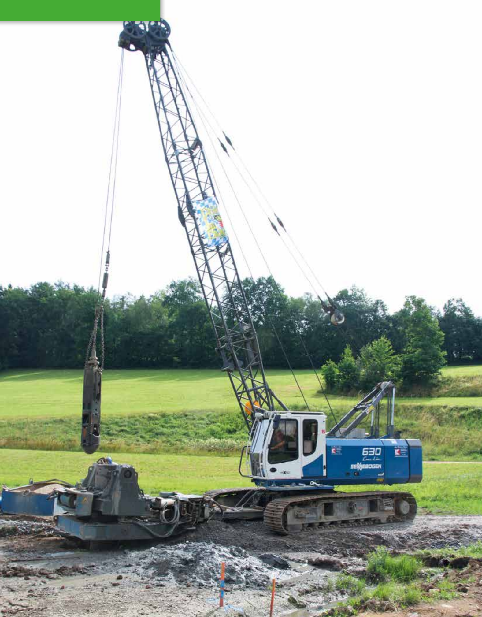
22 630 HD – With additional on board hydraulics to drive a casing oscillator; Germany 630 HD – Mit hydraulischem Zusatzpaket zum Betreiben der Verrohrungsmaschine; Deutschland
