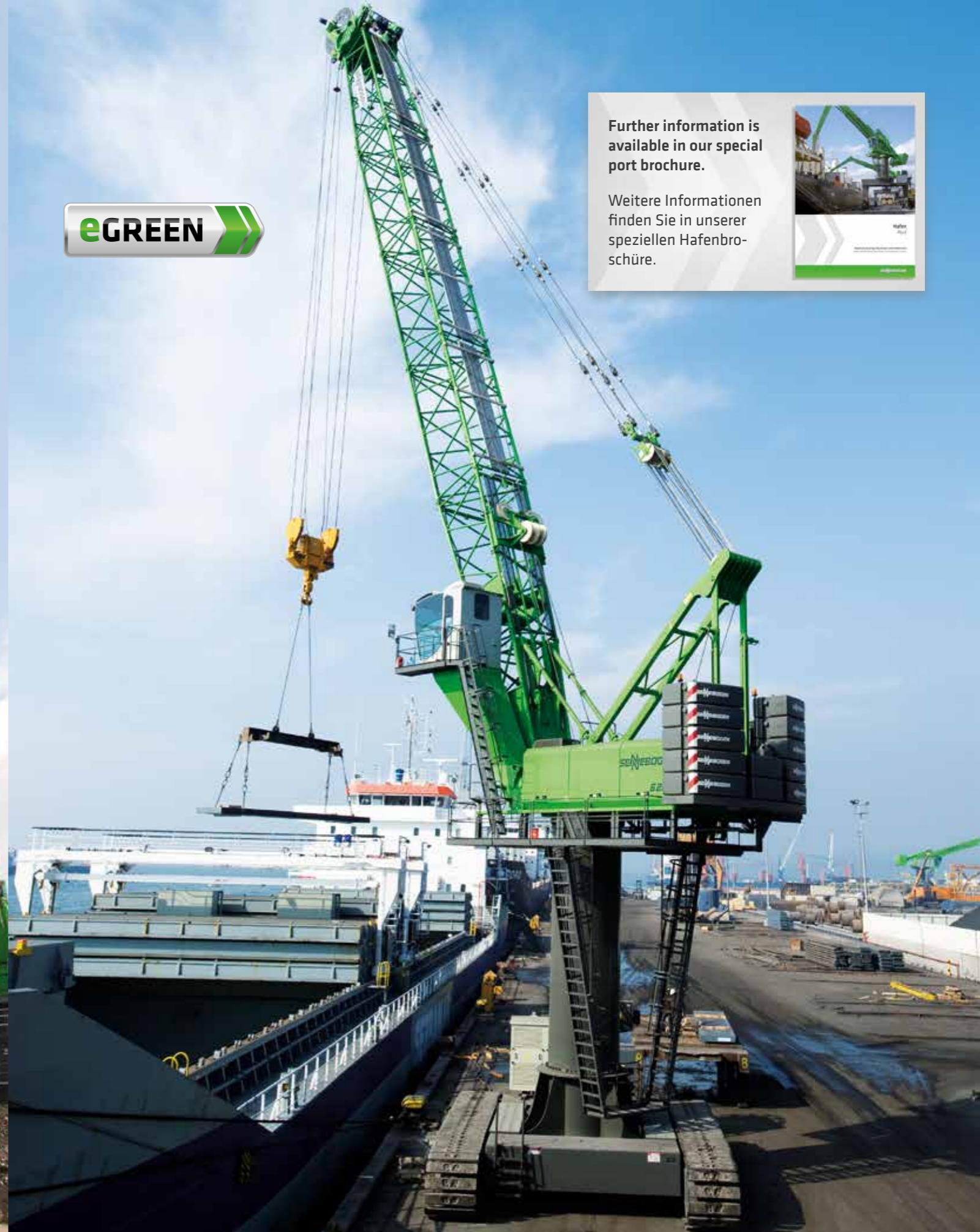
6200 HCC – Electric motor – Cargo handling with 60 t rotatable hook and lifting beam; Turkey 6200 HCC – Elektromotor – Mit 60 t Motorschwenkwerk und Hubtraverse im Stückgutumschlag; Türkei
