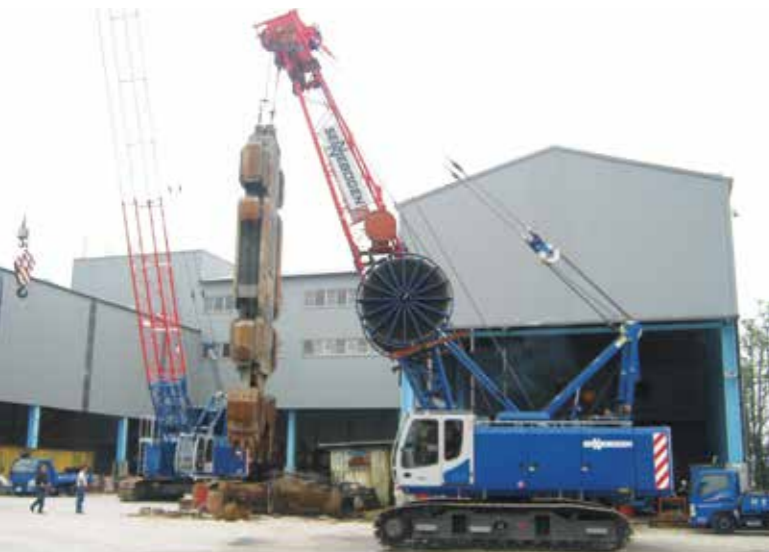
655 HD - With hydraulic diaphragm wall grab; Taiwan 655 HD - Mit hydraulischem Schlitzwandgreifer; Taiwan
