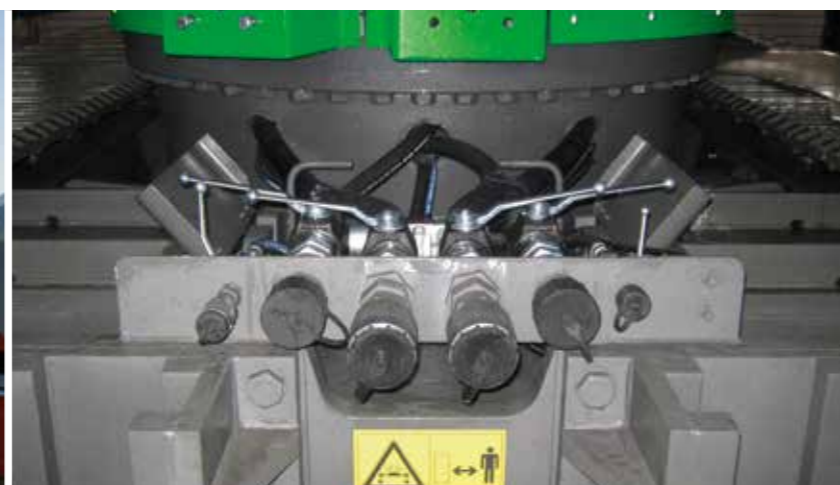
Mechanical connection, hydraulic circuits for casing oscillator equipment on front of under carriage Mechanischer Anschluss, Zusatzhydraulik für Verrohrungsmaschine vorne am Unterwagen
