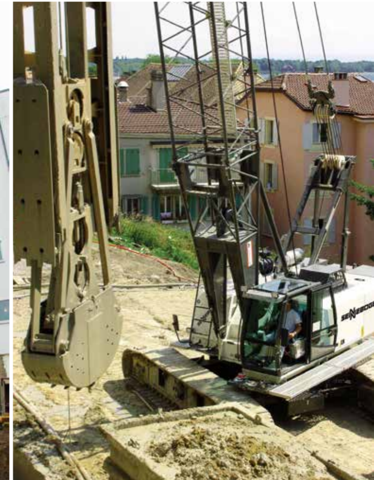
655 HD - With mechanical diaphragm wall grab; Belgium 655 HD - Mit mechanischem Schlitzwandgreifer; Belgien
