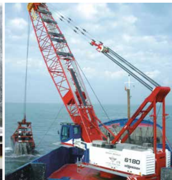
6180 HD – Dredging works with 13 cubic yards bucket; Italy 6180 HD – Einsatz mit Unterwassergreifer mit 10m³ Greifer; Italien
