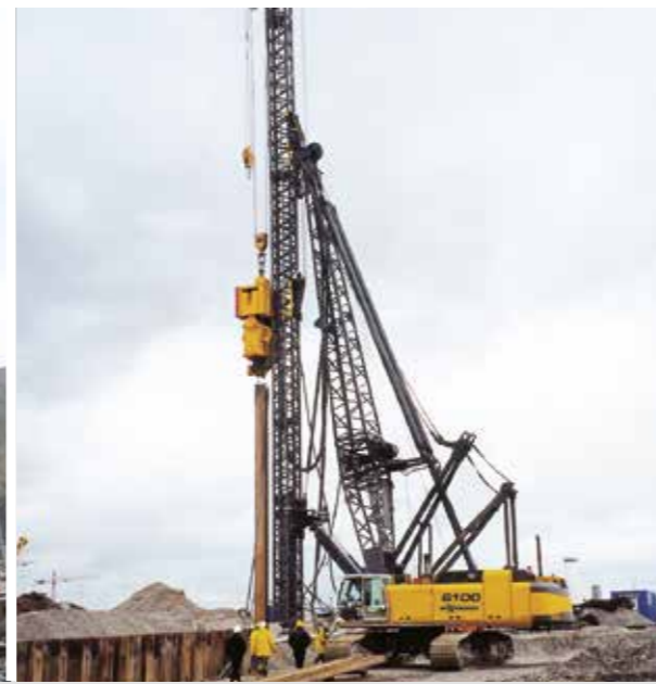
6100 HD - With leader and vibrohammer powered by the crane 6100 HD - Mit Mäkler und Rüttler angetrieben durch den Bagger
