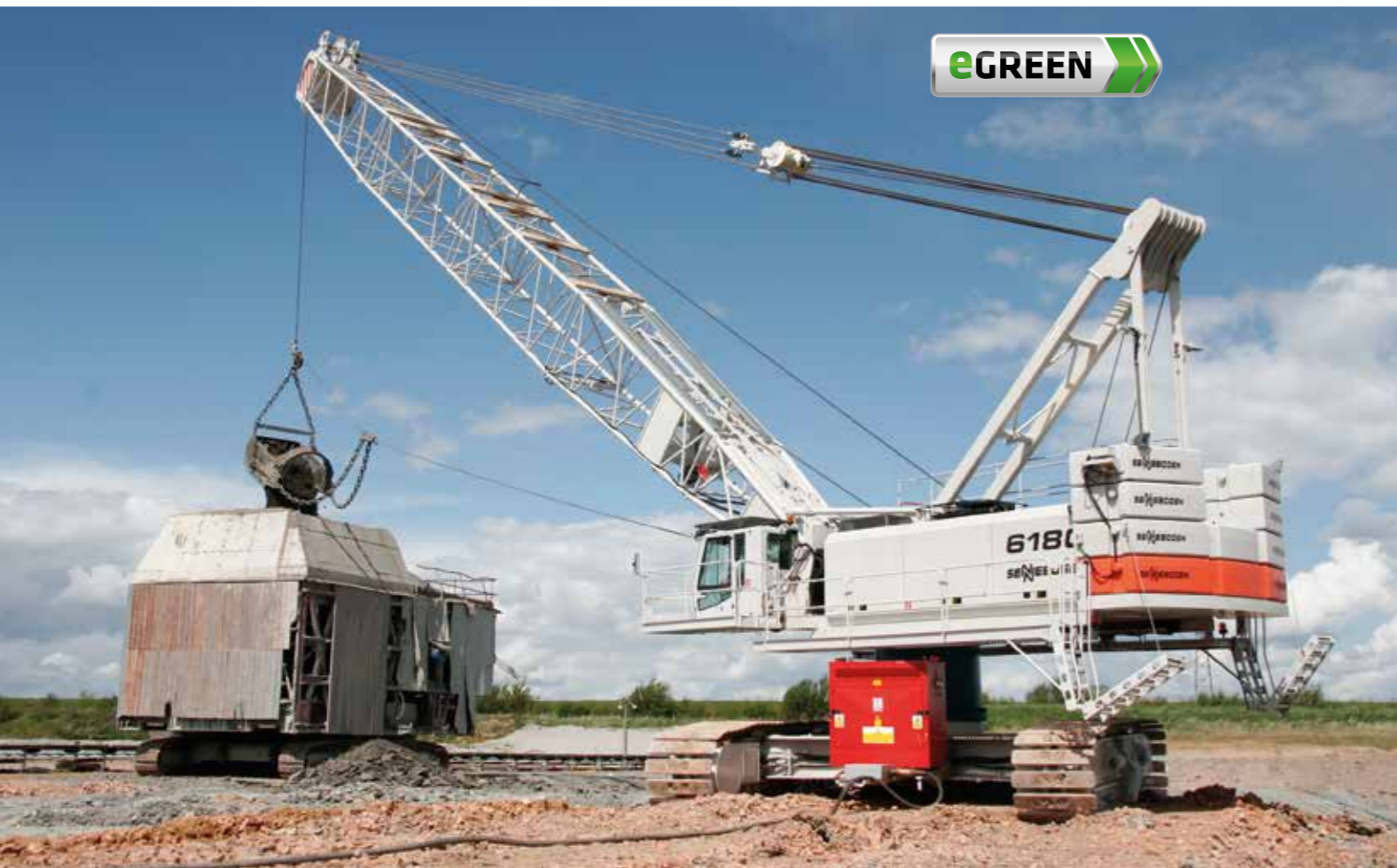
6180 HD – Dragline operation with electric motor with 7,8 cubic yards bucket; Great Britain 6180 HD – Schleppschaufeleinsatz mit Elektromotor mit 6m³ Schaufel; Großbritannien
