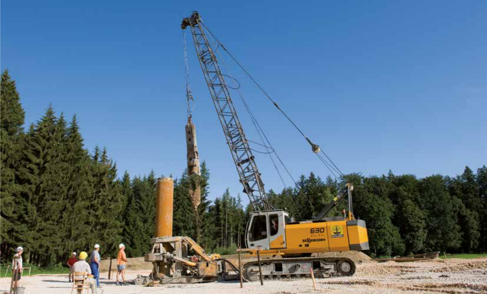
630 HD – With casing oscillator driven by on board hydraulics; Austria 630 HD – Maschine mit integriertem Zusatzhydraulikpaket im Brunnenbauersatz mit Verrohrungsmaschine; Österreich
