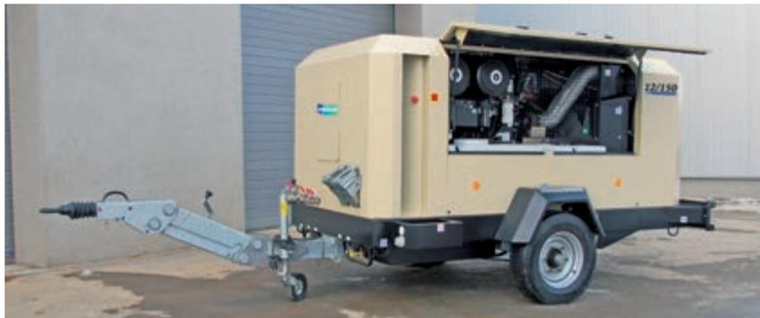
Las puertas de apertura amplia y los drenajes centrales de serie son otra aportación positiva para el mantenimiento del 12/150, cuyas áreas están diseñadas para facilitar la inspección, la reparación y el mantenimiento.
