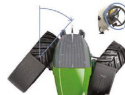
Dzięki układowi kierownicemu VarioActive jeden obrót koła kierownicy wystarcza, by uzyskać maksymalny kąt skrętu.
