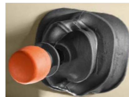
Asystent hamulca ręcznego w położeniu automatycznym: hamulec jest aktywowany automatycznie.
