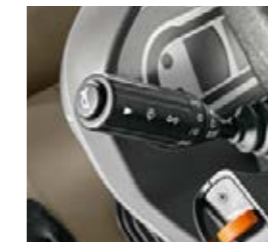
Как во всей технике Fendt, в Fendt 1000 Vario предусмотрены небольшие, практичные детали, призванные облегчить рабочий день, например, автоматический сброс указателя поворота: автоматические индикаторы поворота на тракторе мигают, пока поворот не будет завершен.
