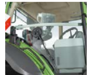
Стеклоочиститель бокового стекла с охватом в 220° даже при сложных условиях обеспечивает отличный обзор с правой стороны.
