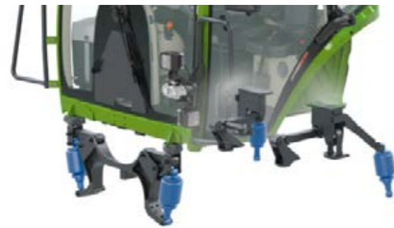
4-точечная, пневматическая система амортизации кабины с интегрированной системой контроля уровня сводит колебания до минимума.
